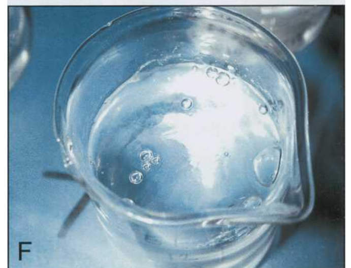
Figure 1. Components of epoxy reaction mixture at 10.3 cm of Hg. E1 hardener (A); E12 polymer (B); E1 and E12 (C); E1 and AE30 glass separator (D); E12 and AE30 (E); E1, E12 and AE30 (F).
